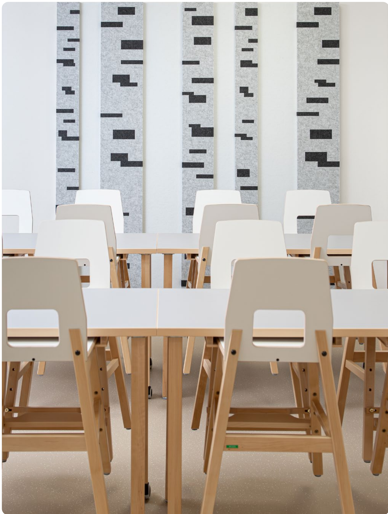
Kuopiossa Sinikellon päiväkodissa ruokailutilassa syödään koivumetsän äärellä. Akustoivasta huovasta valmistettu koivikko vaimentaa tehokkaasti ääntä ja on ilo silmälle.
